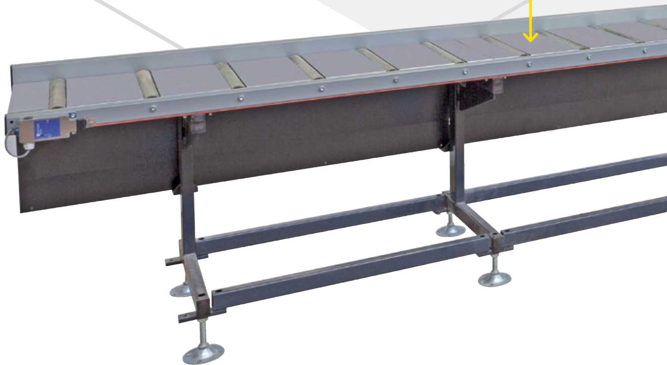
ANSCHLAGROLLENBAHN IN GESCHLOSSENER BAUFORM
