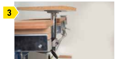
3 Bei Bedarf ist die Vakuumsauggreifer unter die Arbeitsplatte wegklappbar.
