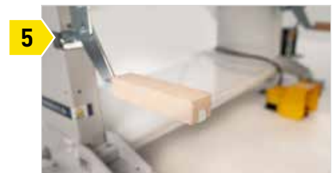
5 Vertikalaufgabe links und rechts verstellbar im 50mm-Schlüsseloch-Raster.
