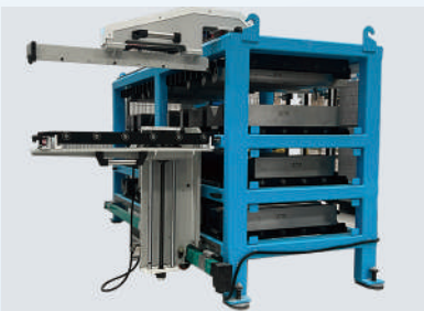
Schwerlastregal für den teilautomatischen Werkzeugwechsel
